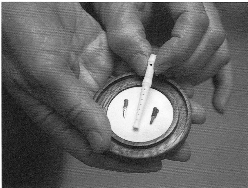
Tages bidrag till Guinness Rekordbok 1994, världens minsta kniv 14 mm lång med smitt blad och tånge genom skaftet och riktig slir/slida. År 2001 med världens minsta blockflöjt svarvad av renhorn, 54 mm lång, och spelbar.
